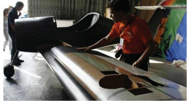
Şekil 3 DynAero Hafif Uçağı Mantar Kompozit Kanat Hücum Kenarı Entegrasyonu (2009)
