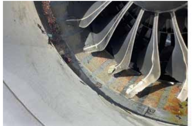
Resimde uçağın sol (1 numaralı) CFM Leap 1-B motorunda kuş çarpması sonrası oluşan hasar görülüyor.
