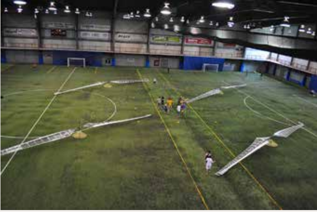
İnsan Gücü ile hareket eden helikopter Atlas'ın yerde ve havada görüntüleri
