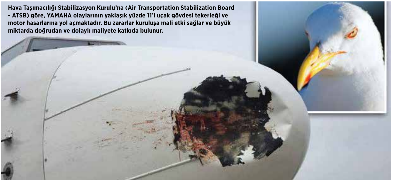
Şekil 1.4.1.1: Hava aracına kuş ya da kuş sürüsünün çarpması sonucu YAMAHA oluşan bölgeler
