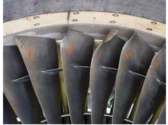
Şekil 1.4.1.2: Hava aracı motoruna küçük bir kuşun girmesi sonucunda türbin motoru kanadında oluşan hasar.
