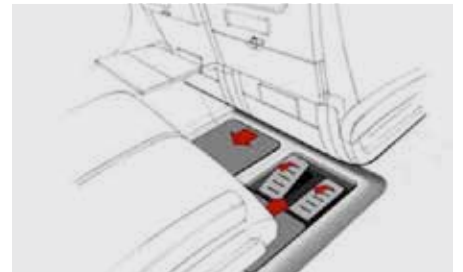
Yukarıda, uçak zeminindeki raylara monte edilen ve uzun yol ekonomi yolcularının tıbbi rahatsızlıklarını azaltmayı amaçlayan pedal sistemi görülmektedir.
