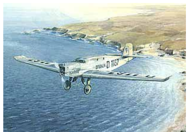
Junkers'in üretmiş olduğu W33 modeli uçak ilk uçuşunu 1927 yılında yapmış ve Bremen adını taşıyan bir W33 uçağı Avrupa'dan Amerika'ya, ara vermeksizin uçabilen ilk uçak olmuştur. Tek motorlu ve saatte 180 kilometre hız yapabilen bu uçaktan 199 adet üretilmişti.
