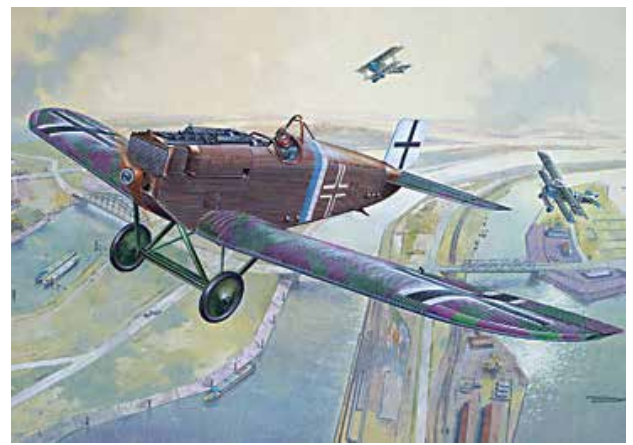
Junkers'in ilk uçuşunu 1917 yılında yapan D.I ya da J 9 modeli düşük kanatlı, monoplane tamamen metal savaş uçağı 41 adet üretilmiştir. Junkers D.I. modeli uçak çelik yerine tamamen yeni bir metal olan duralumin alaşımı kullanan ilk uçaktır. Duralumin yüzde 95 alüminyum ve yüzde 4 bakırdan oluşur. Dayanıklı ve hafiftir.
