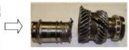
Kalkış tırmanışı sırasında motor milinin kırılmasına neden oldu.
