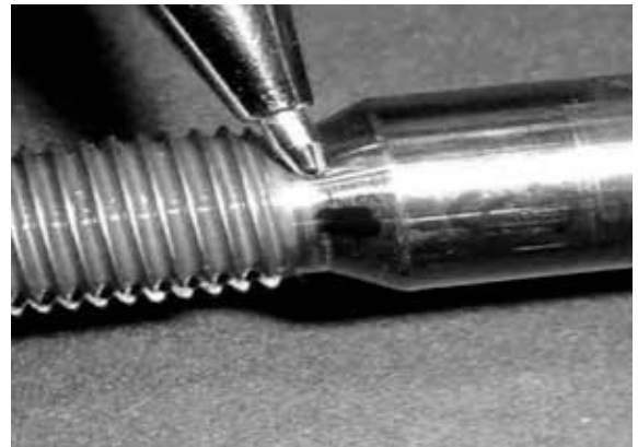
Resim 1 Çatlak tespit edilen mil (actuator shaft)
