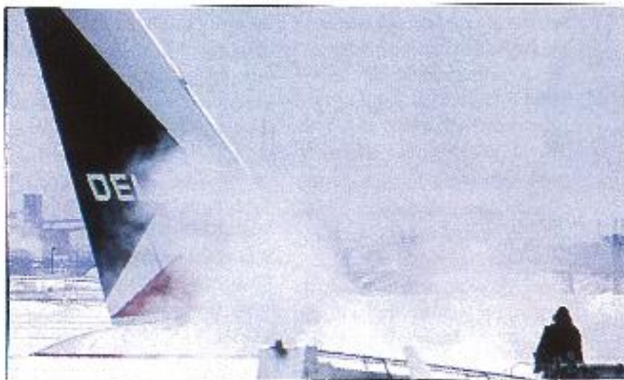
Pilotlar; anti-icing yada de-icing yapılmasına, take-off pozisyonundan önce en uygun ve geç zamanda karar vermelidirler.
