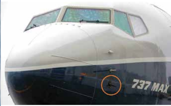
737MAX uçağında kaptan ve F/O tarafında 1'er adet olmak üzere 2 adet AOA sensör bulunmaktadır
