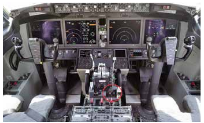
Stab Trim Cutout Switch'lerinin Kokpit içindeki konumu
