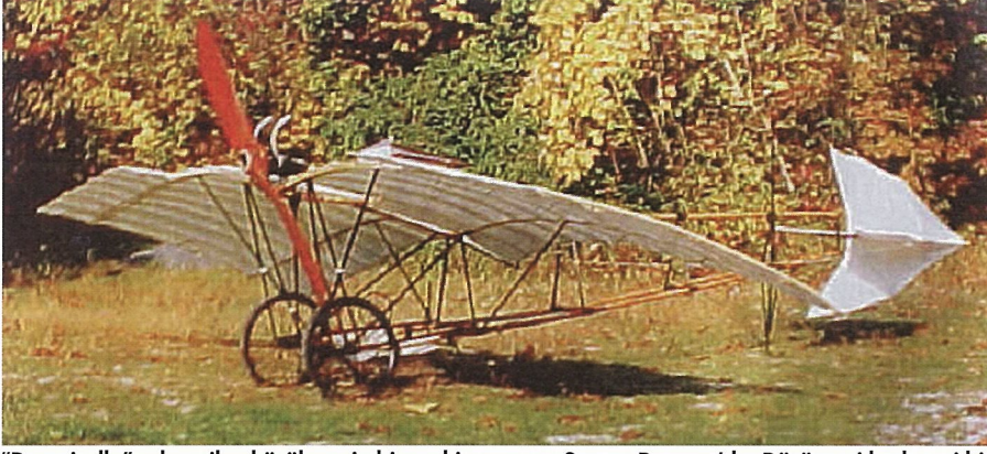
"Demoiselle" adı verilen küçük narin bir makina yapan Santos-Dumont'du. Düşüncesi herhangi birinin evde yapıp uçurabileceği basit bir uçak tasarlamaktır. Gövde bambu çubuklardan yapılmıştı, kanatlar sadece 16.5 ft. açıklığındaydı ve aracın tümü, kanatların altında tekerleklerin hizasında oturan pilot hariç, yalnızca 243 lb. geliyordu.
