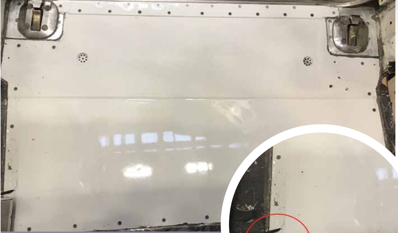
Kırmızı ile daire içerisine alınan noktadaki vidadan dolayı coatroom sökümü yapılmıştır.
