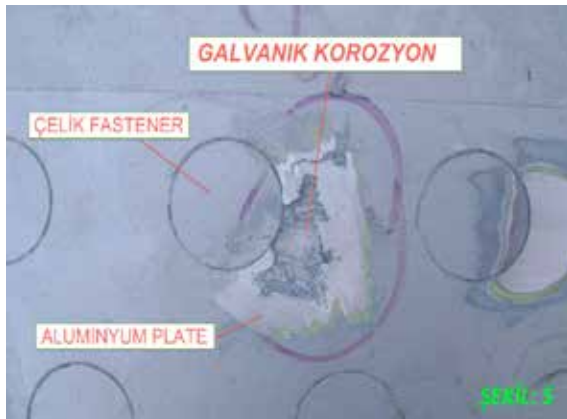
Şekil 7: Lokasyon: Center Fuel Tank upper skin panel.
