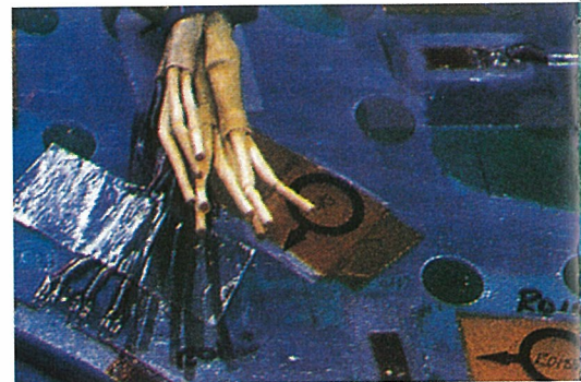
Şekil 2: Yolcu kapı cut-out'unda üç eksenli gage'ler ve kablo donanımı görülmektedir, 777 için 4300 tane gage kullanılmıştır.
