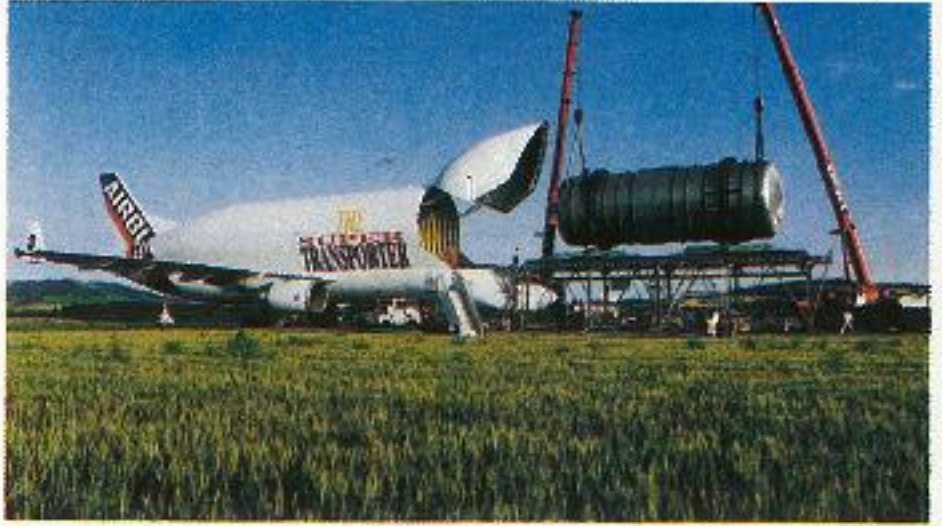
A300-600 ST uçağı ile iki yıl için, merkez Fransa'da bulunan Clermont-Ferrand'tan, Le Havre Limanına 57 feet uzunluğunda gemi tankları taşınması planlanmıştır.
