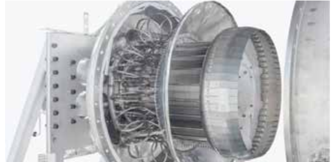
Reaction Engines, motora gelen havayı soğutmak için bir ön soğutucu geliştirdi.
