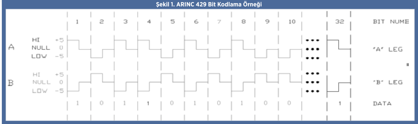
Şekil 1. ARINC 429 Bit Kodlama Örneği
