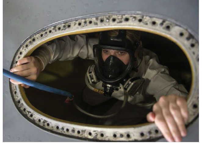
Yakıt sistemlerinde bakım emniyeti; tank girişlerinde güvenli atmosferin sağlanması, doğru KKD kullanımı ve CDCCL kurallarına eksiksiz uyulmasını gerektirir. Arıza giderme süreçlerinde ise AMM ve TSM prosedürleri esas alınmalı, tüm işlemler izlenebilir şekilde kayıt altına alınmalıdır. Yakıt sistemlerinde en küçük bakım hatası dahi yangın, patlama ve ölümcül sonuçlara yol açabileceğinden, emniyet kurallarına tavizsiz uyulması hayati önem taşır.
