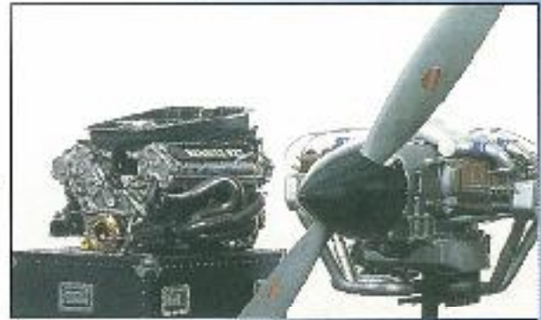
Renault Sport'un 1997'de tanıtılan turistik uçak motoru: 180-300HP'lik, 4 silindirden bir turbo.
